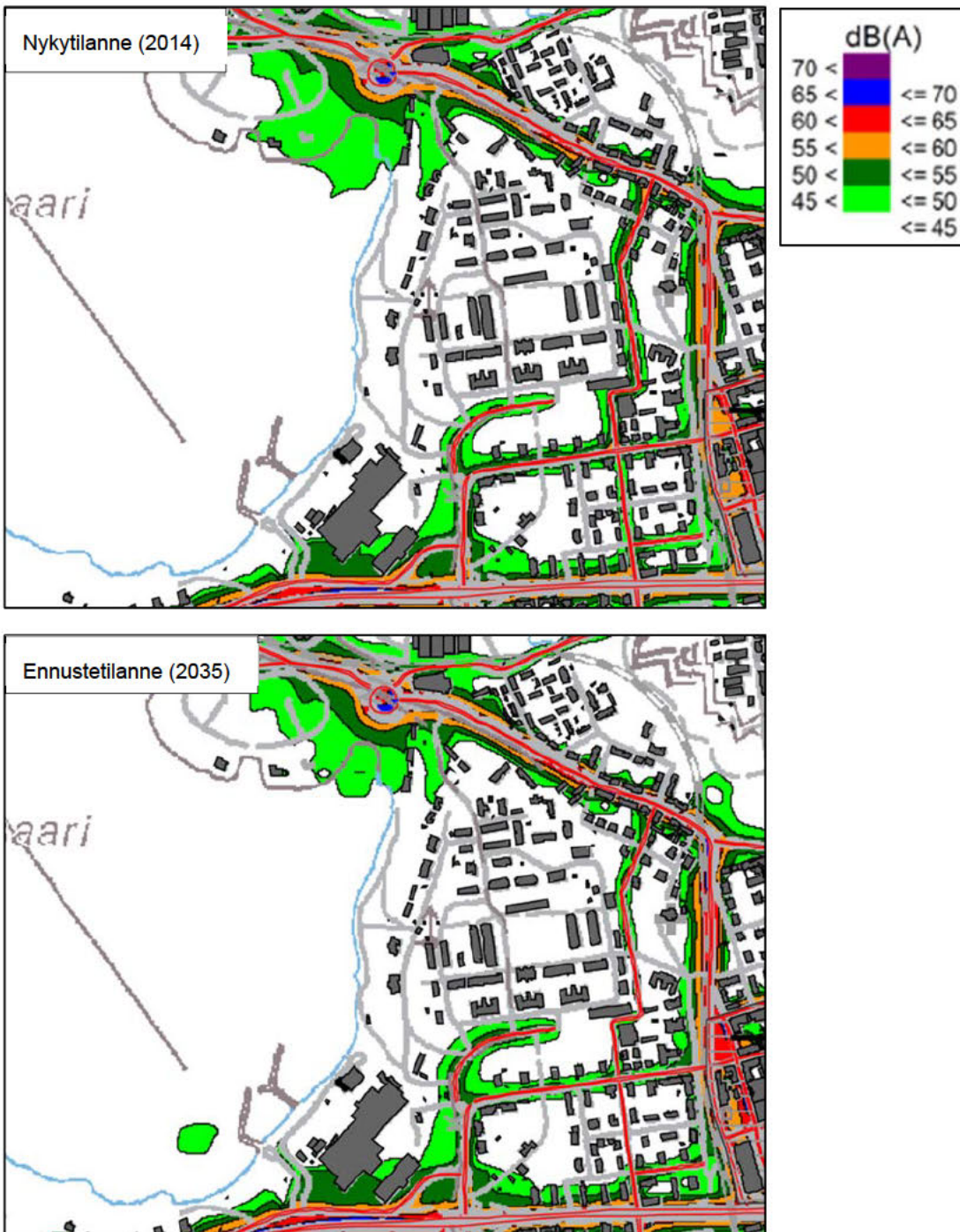
Kuva 13. Nykytilanteen (2014) ja ennustetilanteen keskiäänitasot yöllä. Ylemmässä kuvassa on esitetty yöajan nykytilanteen keskiäänitasot LAeq 22-7 ja alemmassa kuvassa ennustetilanteen v.2035 päiväajan keskiäänitasot LAeq 22-7 (Lappeenrannan seudun ympäristötoimen meluselvitys, Ramboll Finland Oy 2015).
